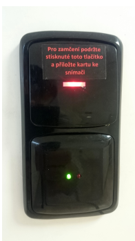
Sestava čtečky karet a potvrzovacího tlačítka dle standardu MU
